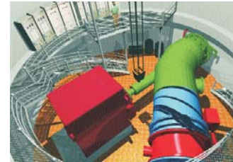
Kraftwerk KW2 Compact-Axial- Turbine 3,8 MW
